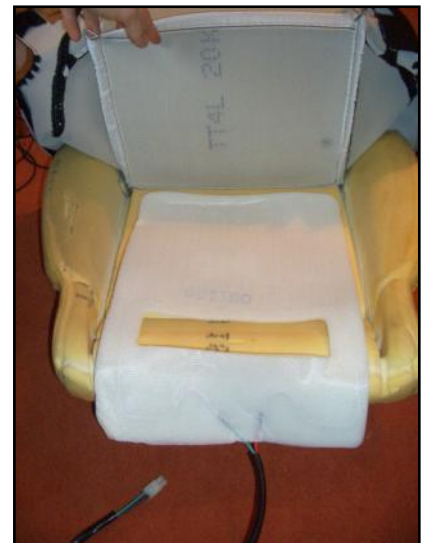
Abb. 11 Heizmatte auf Polster, die Längskabel müssen in die Vertiefung gesteckt werden (dort geht nachher der Draht drüber zur Befestigung des Stoffes)
