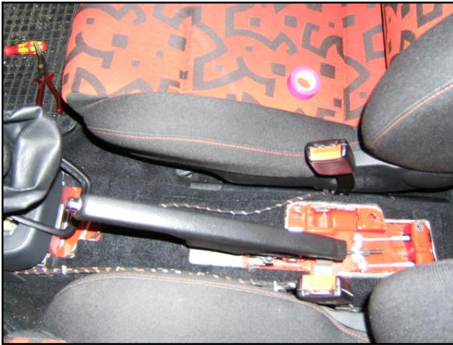
Abb. 40 Kabelverlegung unter der Mittelkonsole
