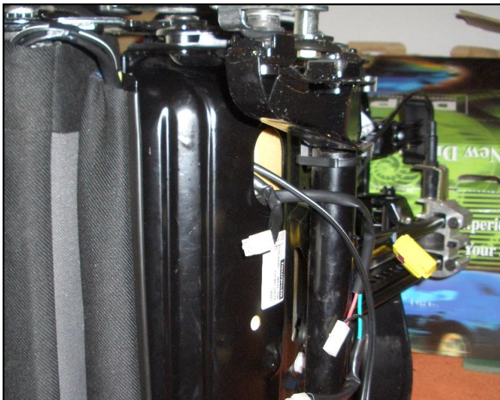
Abb. 17 Durchführung der Kabel, Schutz gegen durchscheuern nicht vergessen
