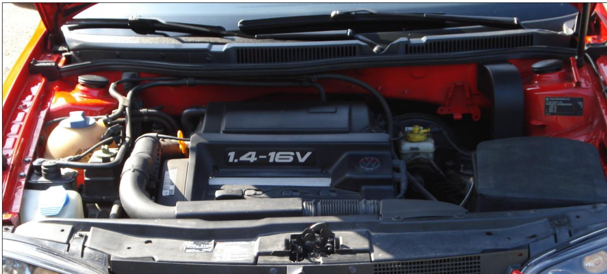
Abb. 1 Motorraum, Batterie rechts unter Kunststoffabdeckung, oder in Textilhülle
