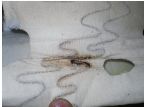
Abb. 43 Verschmorte Stelle bei Heizdrahttechnik
